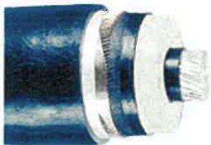
Figur 17. Enfaskabel för markförläggning. Innerst en ledare av aluminium. Utanför ledaren isolation av PEX samt ytterst ett skyddshölje av polyeten. Bildkälla: ABB.
